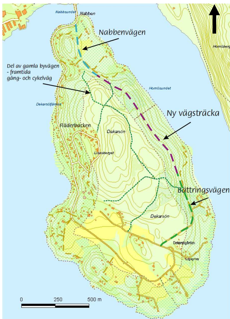
Karta som visar ny vägdragning över ön och del av den gamla byvägen som föreslås bli en gång- och cykelväg.
